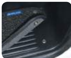
Bouton à pression : fixation sûre et efficace
