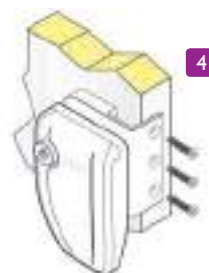
Montage sur le profil de la porte
