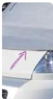
Fixation par aimant pour une tension optimale du volet sans aucun risque pour la carrosserie
